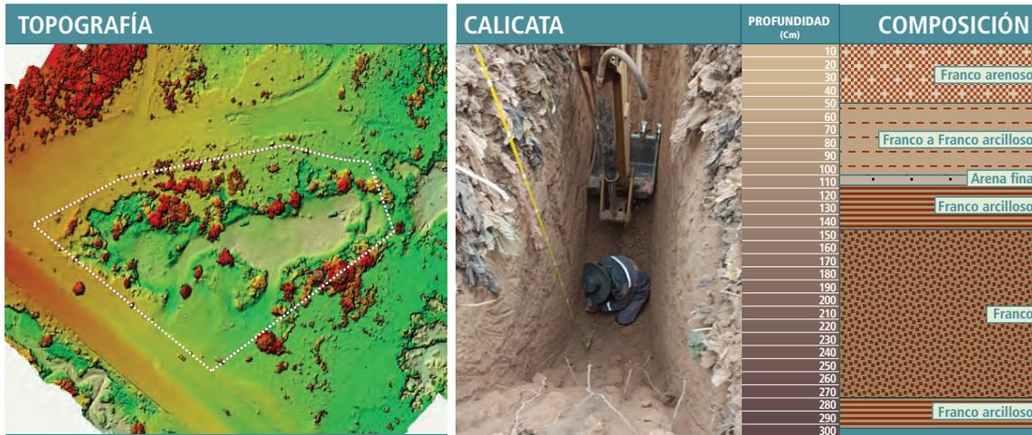
Nota. La figura de la izquierda muestra la topografía del predio. A la derecha se observa la calicata con el perfil de suelo. No se ha encontrado nivel freático hasta los 3,3 m de profundidad. Con base en análisis topográficos, imágenes de satélite y geológicos de la zona, se determina que no existen fallas geológicas dentro el área del botadero de Boyuibe.
